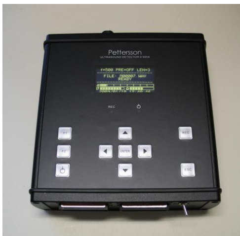
Fot.1. Detektor ultrasoniczny Pettersson D500 wykorzystywany podczas monitoringu nietoperzy na przedmiotowym terenie
